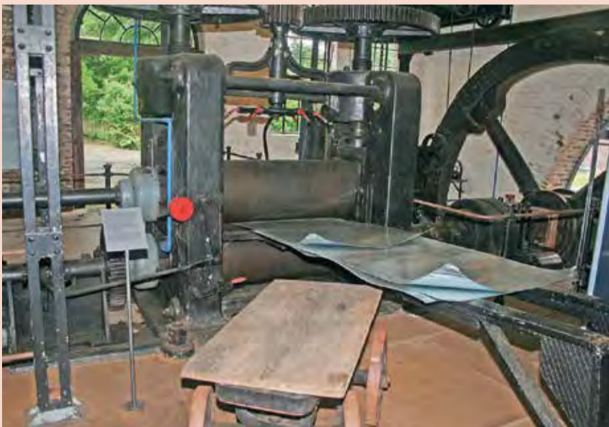
Een stalen wals waarmee vanouds blokken zink (pakketten) tot bladzink werd geplet. Het zogenaamde pakketgewalste zink. Foto: K. Boeder.
